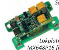
Die spezielle Lokplatine mit aufgestecktem MX648P16 für Fleischmann „Berg“ Lok.
