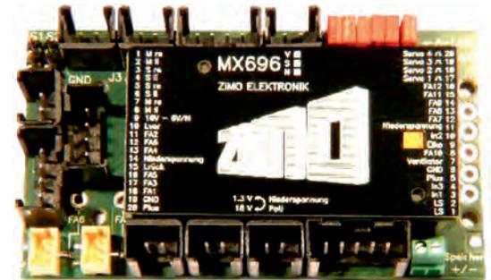
Lokplatinen mit aufgestecktem Decoder MX696S
