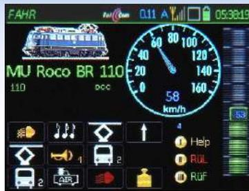
◀ Fahrpult im Funkbetrieb (mit Antennensymbol oben)
