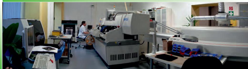
ZIMO Produktion Maschinenraum: zwei Bestückungs-Automaten, Reflow-Lötöfen, Lötpastendrucker, AOI-Gerät
