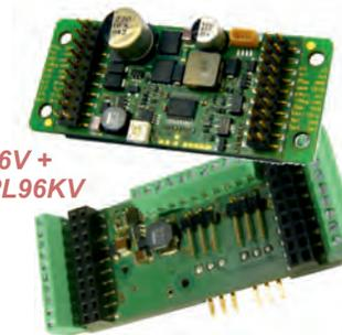
Diese Kombination (Lokplatinen LOKPL96KV mit aufgestecktem Decoder MX696V) ist als eigener Decoder-Typ **MX696KV** erhältlich (siehe Seite 23), mit ähnlichen Eigenschaften wie MX695KV, aber schmale Bauform!
