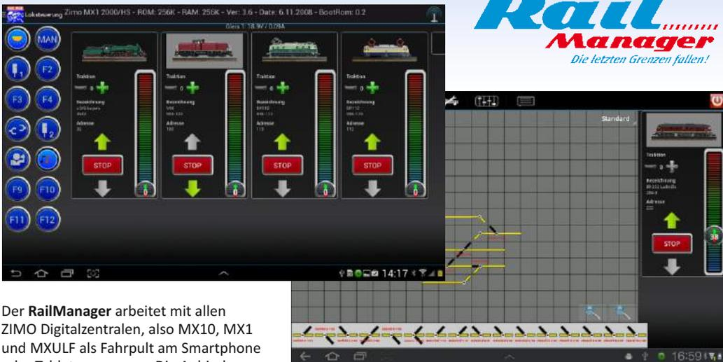
Der **RailManager** arbeitet mit allen ZIMO Digitalzentralen, also MX10, MX11 und MXULF als Fahrpult am Smartphone oder Tablet zusammen. Die Anbindung erfolgt per WLAN, Bluetooth oder über einen PC.
