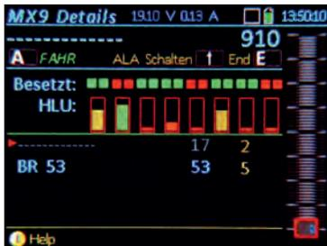
◀ Einstellungen für HLU Fahrstufen (eine ZIMO Spezialität): dieses Bild zeigt den Zustand von Gleisabschnitten eines MX9 Moduls. Besetztmelder, HLU Fahrstufen (max. 7 Fahrstufen) und die erkannte Triebfahrzeugadresse.
