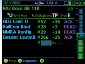
◀ Das Auslesen und Programmieren mittels RailCom erfolgt (soweit es sich um einen ZIMO Decoder handelt) in einer sehr langen Liste mit Klartext. Dadurch ist der Überblick aller schon „behandelten“ CVs gegeben, diese können auch jederzeit nochmals verändert werden.
