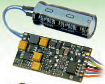
Energiespeicher (oft auch „Pufferkondensatoren“ genannt), am Decoder angeschlossen, haben oft großen Nutzen:
