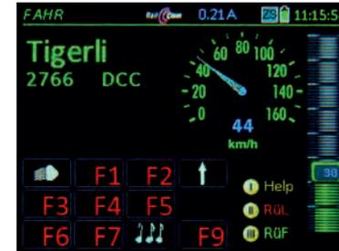
◀ Eine Mischung aus **FAHR** Bildschirm und Zubehör-Adressliste (Weichen oder Signale): es werden die Zubehördecoder-Adressen und die jeweilige Position der vier angeschlossenen Ausgänge angezeigt. Hier kontrollieren die Funktionstasten die Weichenstellungen.
