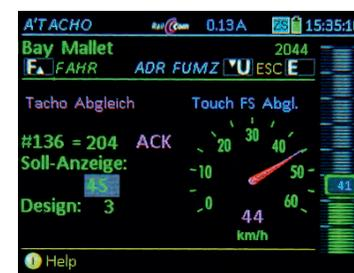
◀ Mit ZIMO Decodern (oder Decodern anderer Fabriken mit RailCom) wird die echte Geschwindigkeit mittels RailCom Rückmeldung angezeigt. Der Bildschirm links dient dem automatischen Abgleich des Tachos durch direkte Programmierung der CV # 136.
