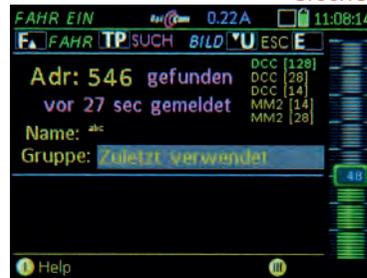
Das funktioniert auch bei Vollbetrieb der Anlage, vorausgesetzt dass der zu findende Decoder „mitspielt“, also ein ZIMO Decoder mit passender Software ist.
