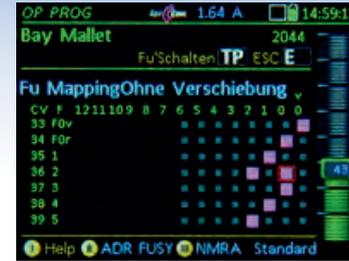
◀ Für alle gängigen „Mappings“ hält das MX32 eigene Displays bereit: Standard NMRA CV Mapping (mit oder ohne Linksverschiebung), Schweizer Mapping, ZIMO Eingangsmapping, ZIMO Mapping der Funktionssounds und Lautstärken. Das Bild zeigt das Schweizer Mapping, um komplexe Lichtfunktionen inkl. Abhängigkeiten einzustellen.
