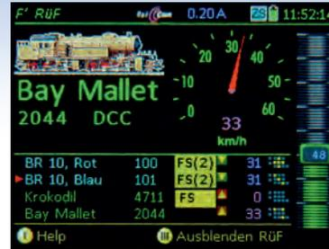
**FAHR** Bildschirm des Fahrpultes MX32: das aktuelle Fahrzeug wird mittels Schieberegler und F-Tasten gesteuert. Dazu gibt das Display Auskunft über sämtliche Betriebszustände, Funktionen, Weichen- und Signalstellungen, etc...
