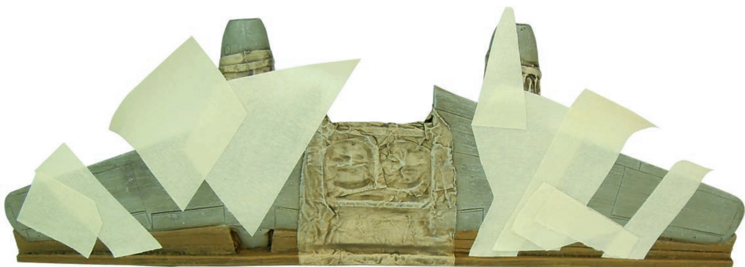
Ableben der Lackierflächen mit zugeschnittenem Kreppband.
